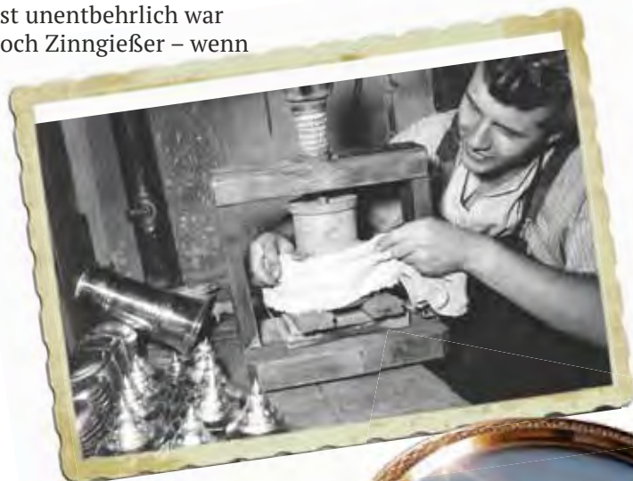
Nach dem Guss wird die Form für den Krug gekühlt
